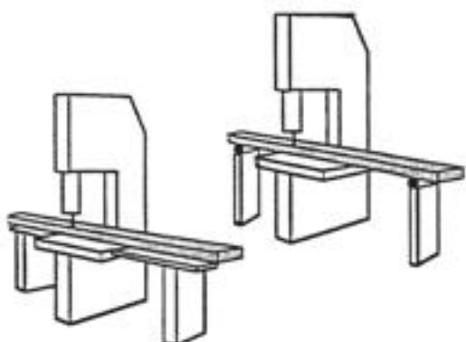
Fig. 11: Longitudinal cut
