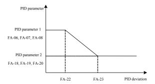
Fig.5-23 PID parameter switching
